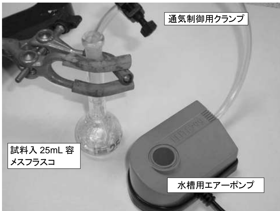
図2. グルコースオキシダーゼとカタラーゼによる D-グルコース酸化用通気装置
