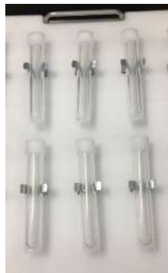
図1. 振盪恒温槽中で試験管ホルダーにポリプロピレン試験管を装着した状態
