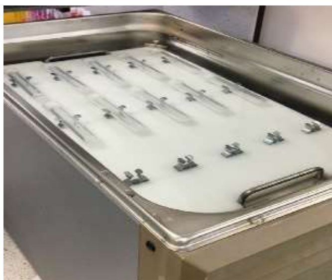
図1. 振盪恒温槽中で試験管ホルダーにポリプロピレン試験管を装着した状態
