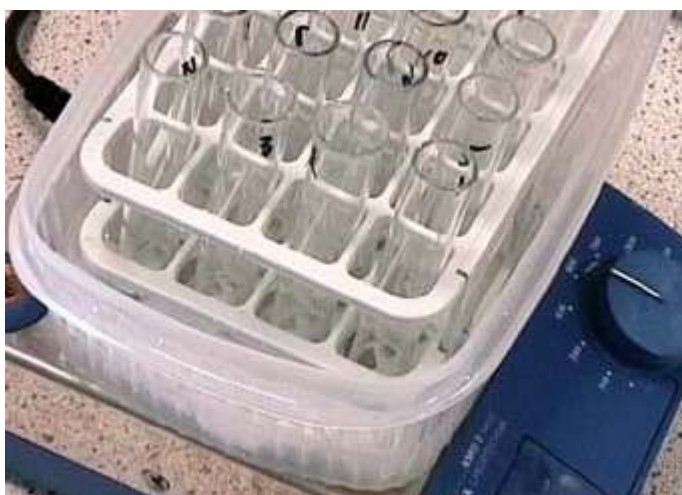
図1. 2M KOHによるRS可溶化処理時の マグネティックスターラーと氷冷水浴 の状況
